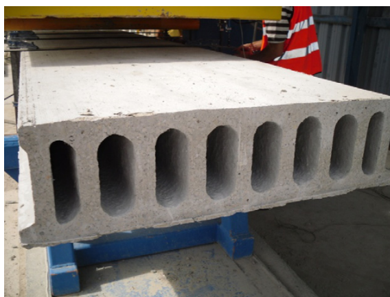
Figura 3 – Laje alveolar em processo de produção por extrusão.
